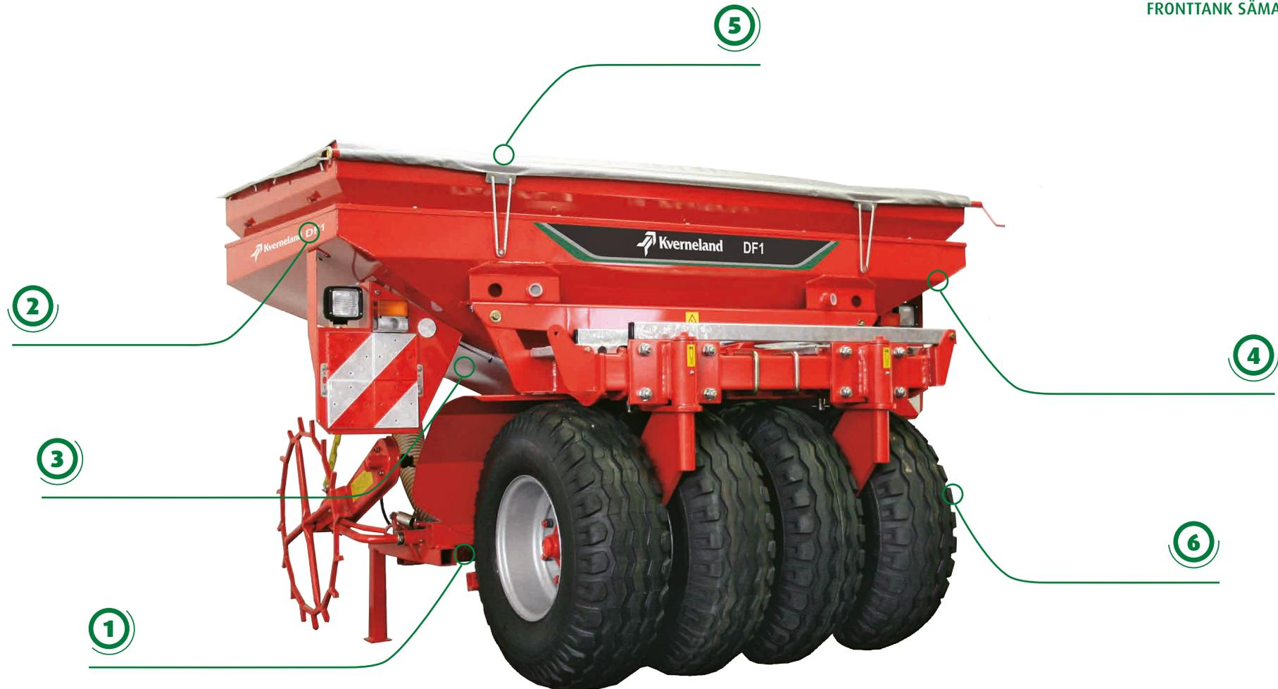
**1** Für eine gute Zugänglichkeit befindet sich das Dosiergerät unterhalb des Saatguttanks
