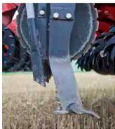
Die Einarbeitung von Düngern während der Erzeugung der Streifen stellt eine der grundlegenden Eigenschaften des Stripp-Tills dar. Eine Besonderheit ist, dass die Einstellung von Zinken und Düngerrohr unabhängig erfolgen kann. Dies bedeutet, dass bei konstanter Tiefe für die Düngerausbringung die Arbeitstiefe der Zinken verändert werden kann und umgekehrt. So kann das Düngerdepot exakt in der gewünschten Tiefe positioniert werden.
