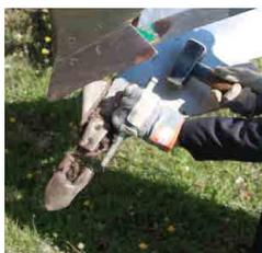
Knock-on® – schneller und einfacher Verschleissstückwechsel
