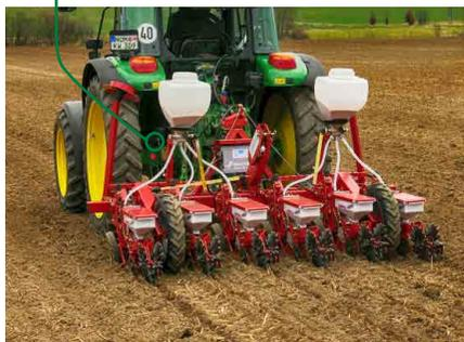
**Monopill - parallelhydraulischer Rahmen**
