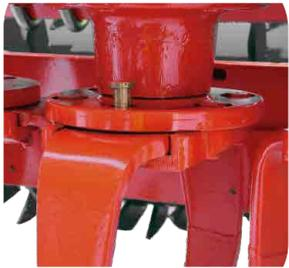
Das Quick-Fit Schnellwechselsystem sichert einen schnellen Zinkenwechsel ohne Werkzeug
