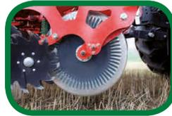
Die Frontschneidscheiben öffnen den Boden und zerschneiden Ernterückstände, die von den folgenden Räumsternen leicht aus der Reihe entfernt werden können.
