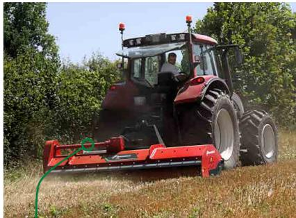
Die hydraulische Seitenverschiebung des FRH ermöglicht das Mulchen von Feldrändern, Obstplantagen und Straßenrändern. Verfügbar von 2,35 bis 3,20 m Arbeitsbreite.
