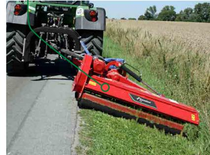
Der doppelte Anbaubock und die hydraulische Seitenverschiebung machen die FRO und FRD Mulcher zum Multitalent beim Mulchen von Feldrändern und Brachflächen. Verfügbar von 2,35 bis 3,25 m Arbeitsbreite.
