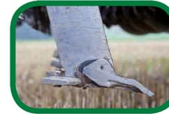
Spezielle Schare lockern den Boden bis zu einer Tiefe von 30 cm. Abhängig von den Bodenverhältnissen können drei verschiedene Zinkenformen verwendet werden dies ermöglicht Arbeitsgeschwindigkeiten von bis zu 12 km / h.
